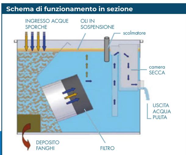
La serie IP è progettata appositamente per la rimozione degli oli superflui e idrocarburi che contaminano i lubrorefrigeranti presenti nelle vasche delle macchine utensili.
