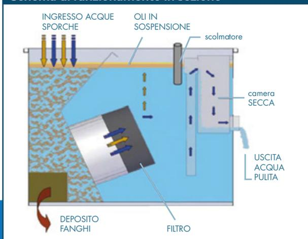
La serie IP è progettata appositamente per la rimozione degli oli superflui e idrocarburi che contaminano i lubrorefrigeranti presenti nelle vasche delle macchine utensili.
